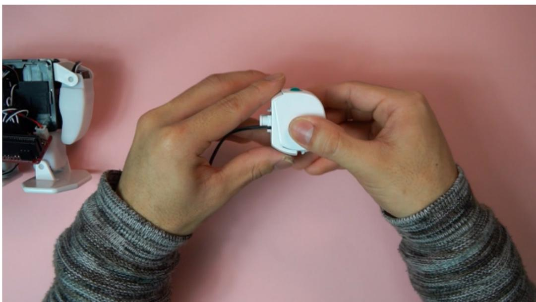
7. 目玉基板用ケーブルをボディの首部分の穴に通して前面へ出し、頭パーツはボディの首部分に差し込んで取り付ける
