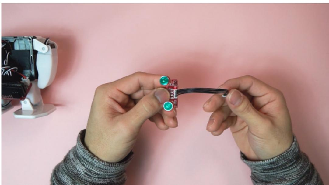
3. 目玉基板のLEDのネジを3mm<sup>ていどゆる</sup>程度緩める
