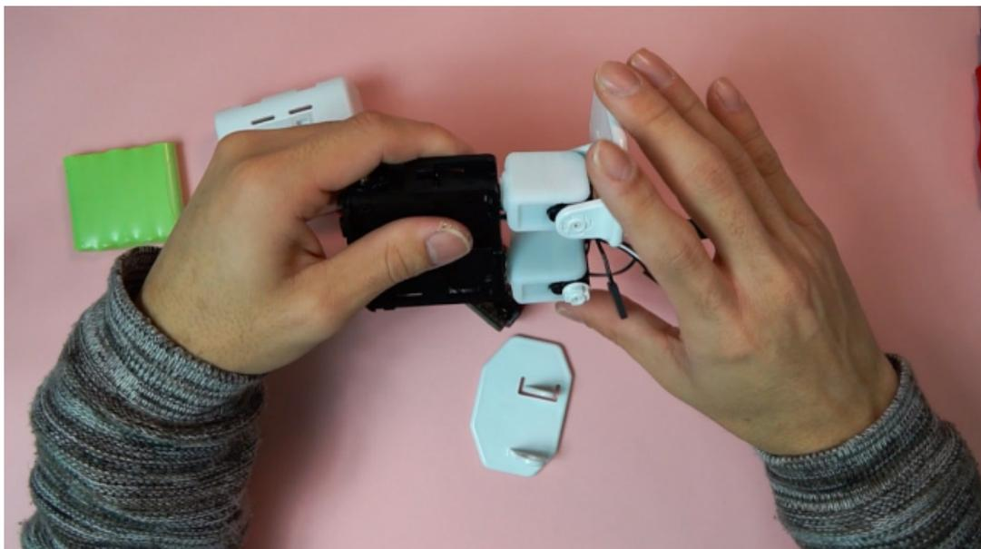
6. 取付けが完了したら、サーボモーターをコントロール基板から取り外しておく<sup>かんりょう</sup>
