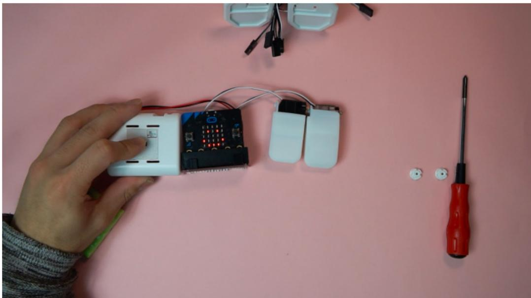
4. 2,6番のサーボモーターの回転軸を上にし、サーボホーン<sup>かいてんじく</sup>の向きを写真のようにして取り付ける
