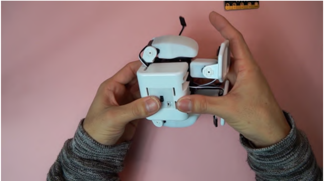
3. サーボモーターのケーブルをコントロール基板へ順番通りに接続する じゅんばんどお
