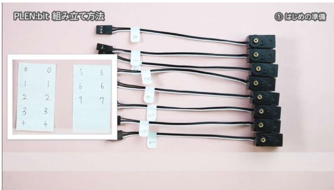
番号シールの貼り付け
