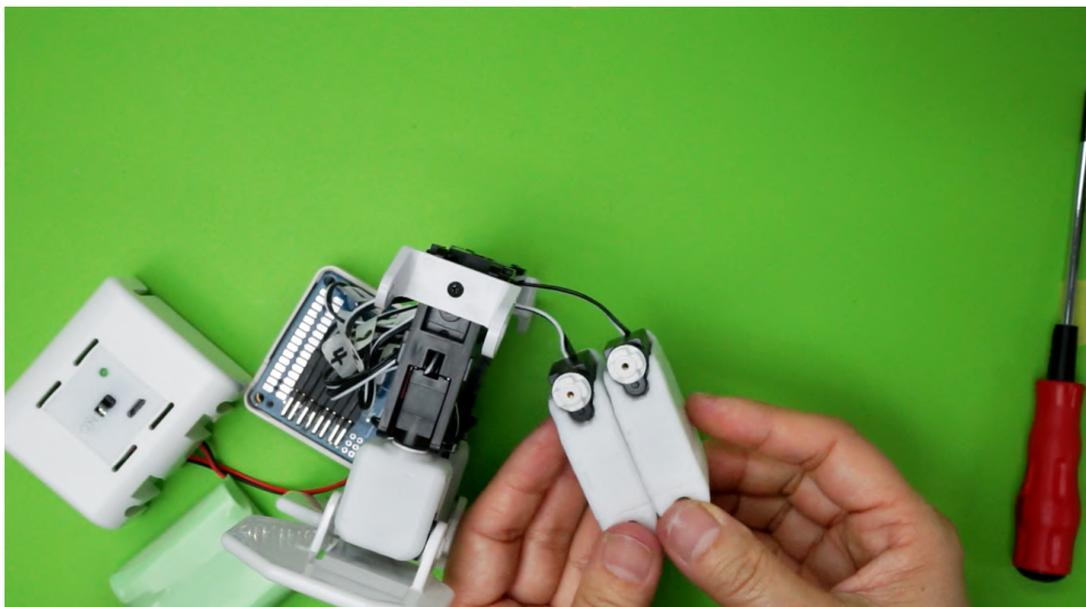
5. 写真のように、パーツの左右と角度に注意しながら、サーボホーン側から腕パーツを取り付ける
