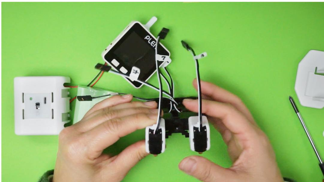
2. 3,7番のサーボモーターをコントロール基板に接続して、スイッチ基板のスイッチを入れ直す
