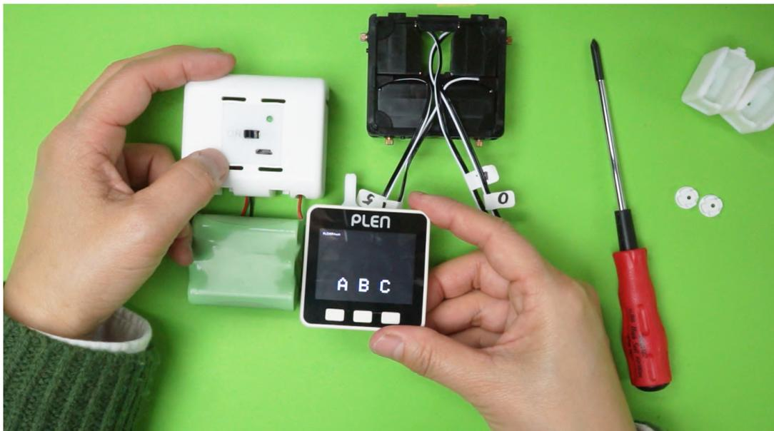
3. 1,5番のサーボモーターの回転軸を上向きにし、サーボホーンの向きを写真のようにして取り付ける
