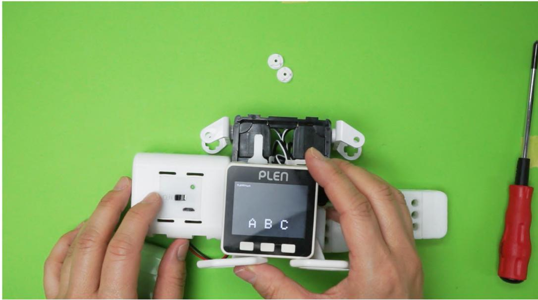
4. 2,6番のサーボモーターの回転軸を上にし、サーボホーンの向きを写真のようにして取り付ける
