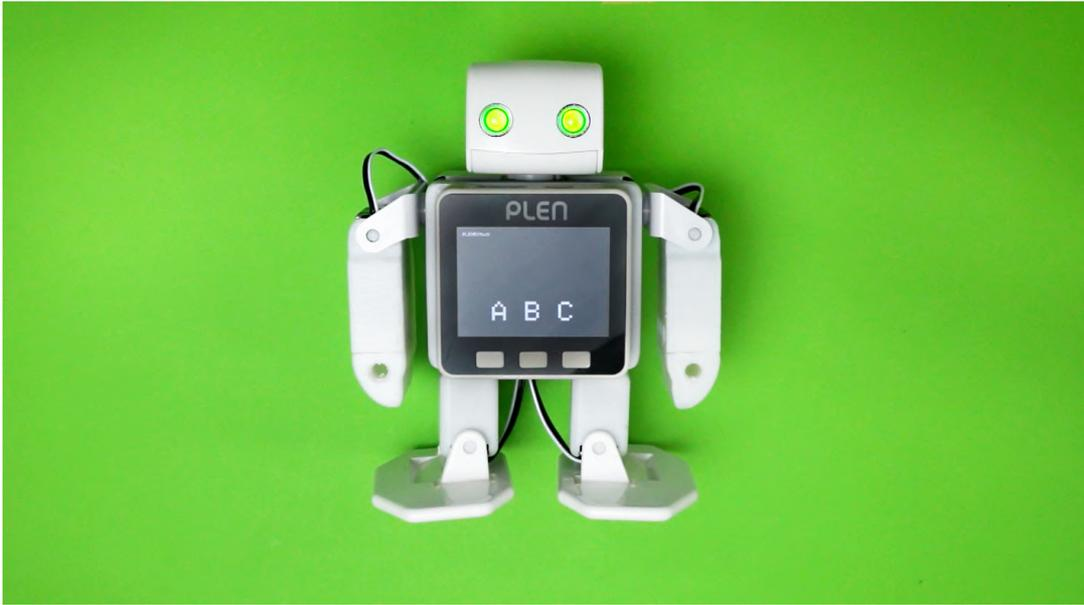
6. M5StackのAボタン、Bボタン<sup>お</sup>を押して手足が動作することを確認する。Cボタンで目玉LEDが点滅する
