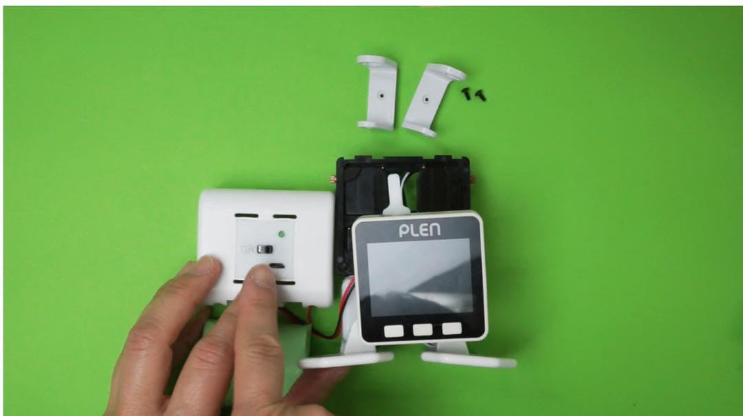
3. 写真のように、パーツの左右と角度に注意しながら、なるべく水平になるように肩パーツを取り付けてねじで固定する
