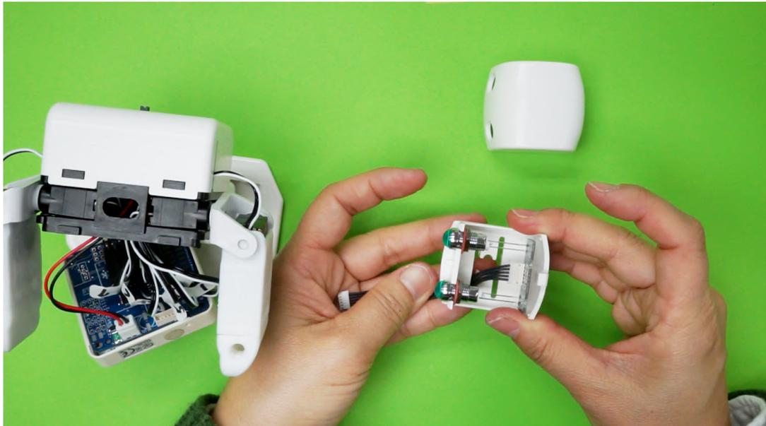
6. 目玉基板用ケーブルをボディの首部分の穴に通して前面へ出し、頭パーツはボディの首部分に差し込んで取り付ける
