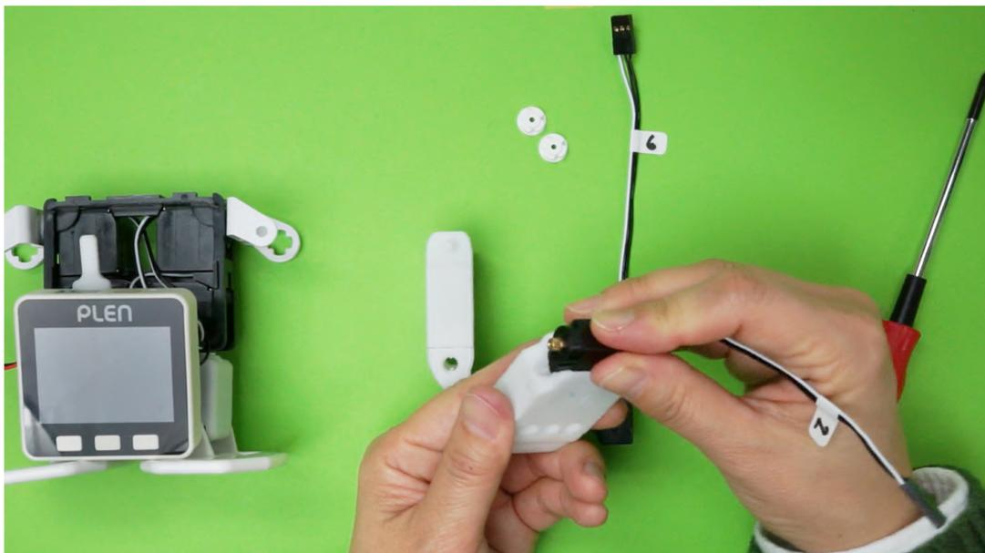
2. 2,6番のサーボモーターをコントロール基板に接続して、スイッチ基板のスイッチを入れ直す
