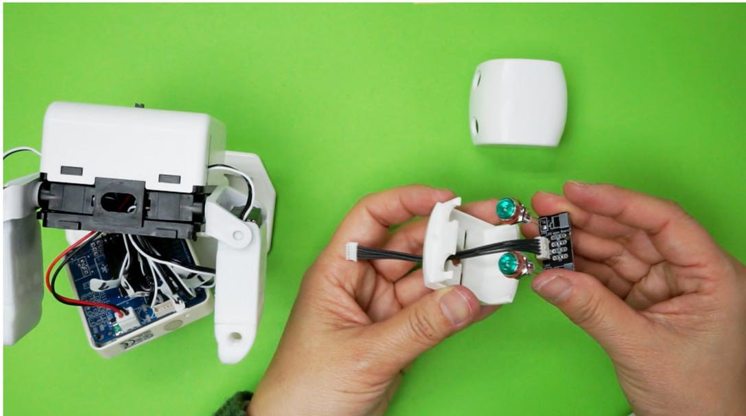
5. LEDを頭パーツ(下)の目玉部分のくぼみにはめ込んでナットを締める<sup>し</sup>
