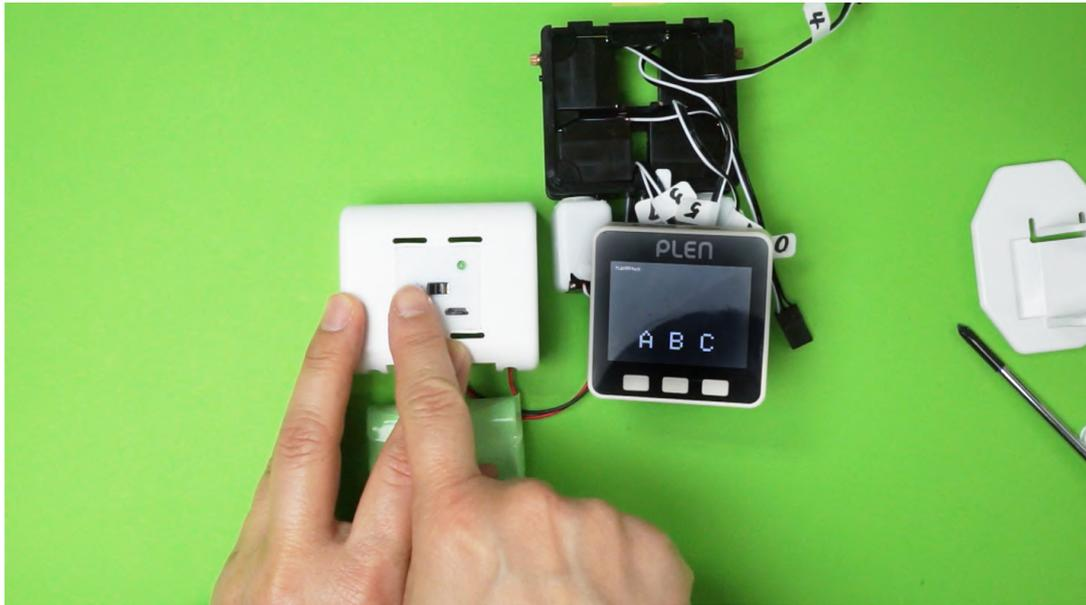
4. 3,7番のサーボモーターの回転軸を上にし、サーボホーンのようにして取り付ける
