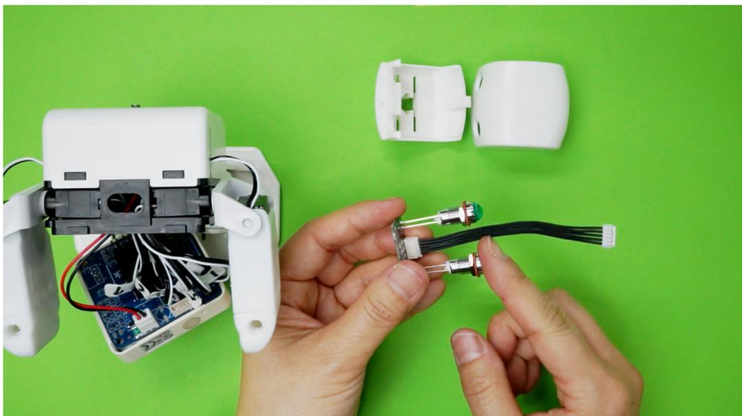
3. 目玉基板のLEDのネジを3mm程度緩める
