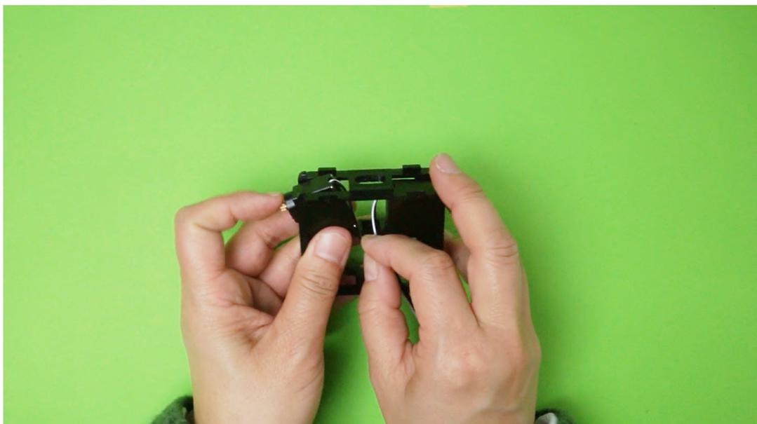
3. 1番のサーボモーターのケーブルを挟み込まないように、写真のようにして組付けていく
