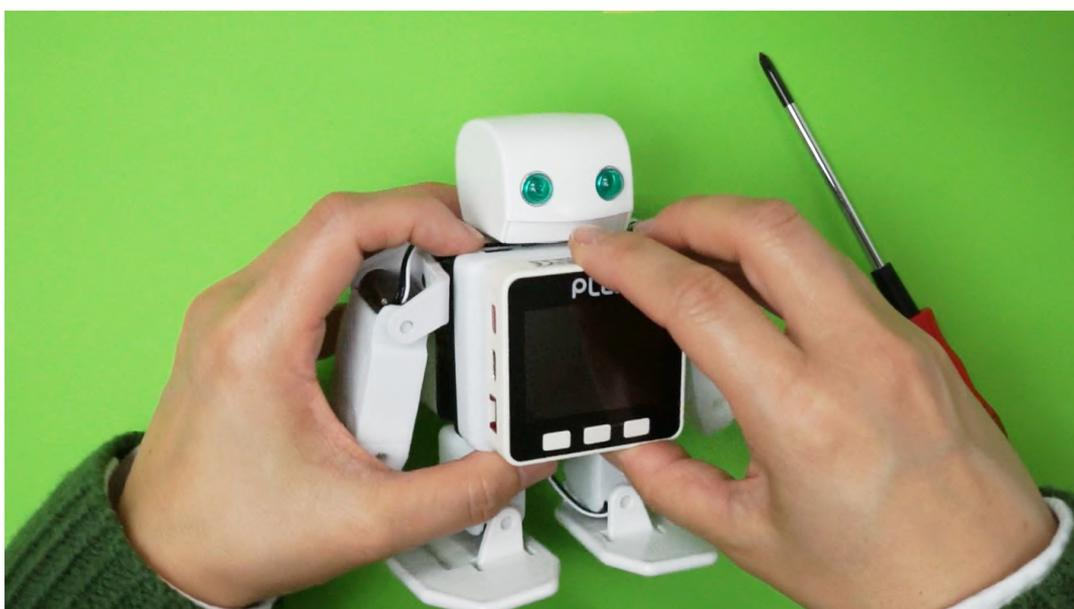
5. スイッチ基板のスイッチを入れ直し、全てのサーボモーターが回転し、初期位置化されることを確認する
